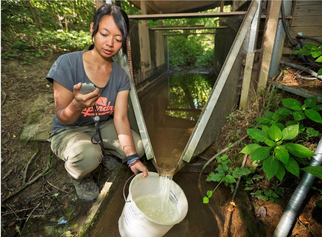
Das Messwehr muss mit Hilfe einer händischen Abflussmessung immer wieder kontrolliert werden. Dies führt ein\*e Projektmitarbeiter\*in durch.
