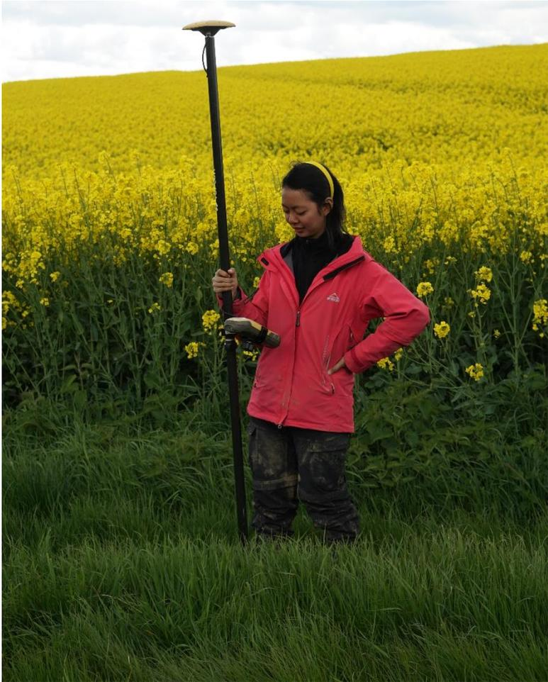
Die Projektmitarbeiterin bestimmt im Feld mit Hilfe eines GPS-Geräts die genaue Position der vergrabenen Sensoren.
