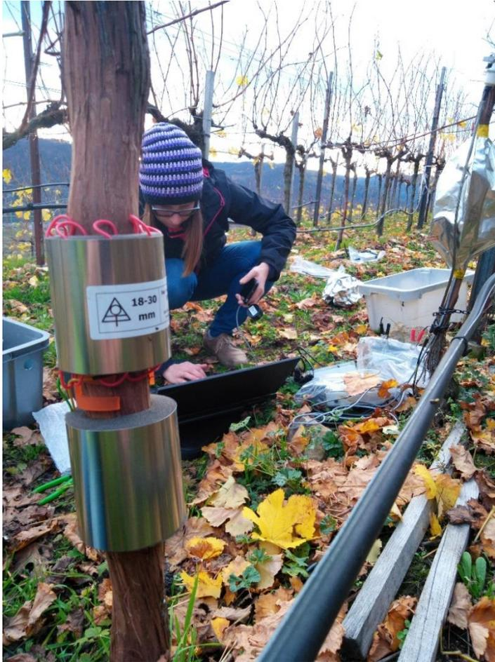
Mit Hilfe eines Saftstrommessgeräts wird der Wassertransport in der Weinrebe gemessen. Die Projektmitarbeiterin liest die gespeicherten Daten aus.
